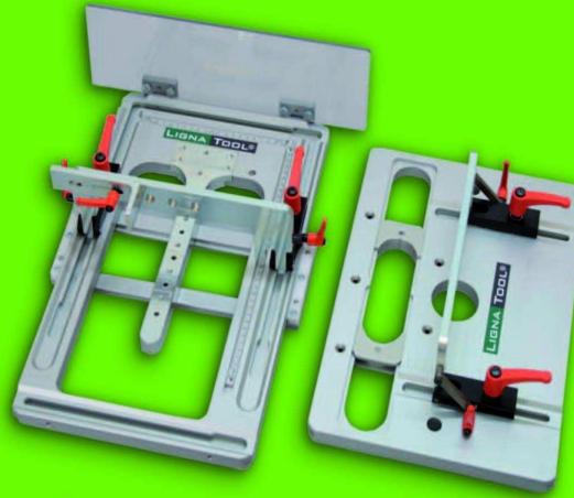
Zapfenfräser mit Wendemesser und Fase-Schneider
